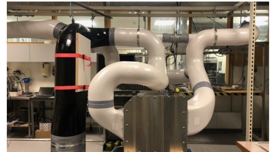
CFD (Computer Fluid Dynamics) analys har verifierats i CTTs system-testlabb med hjälp av en skala 1:1 modell.
