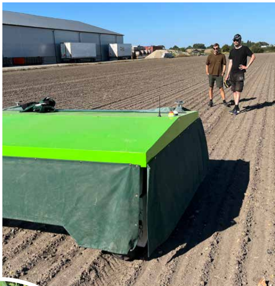
Just nu testas olika hastigheter och hur ofta roboten behöver passera lökraden för att göra ett fullgott jobb. Även gör man tester med att kunna ogräsbekämpa närmare raden för att komma åt ogräs som kryper in och skyddar sig i raden. Dvs minimera den hackade ytan och få bort ett ogräs som trampört.
