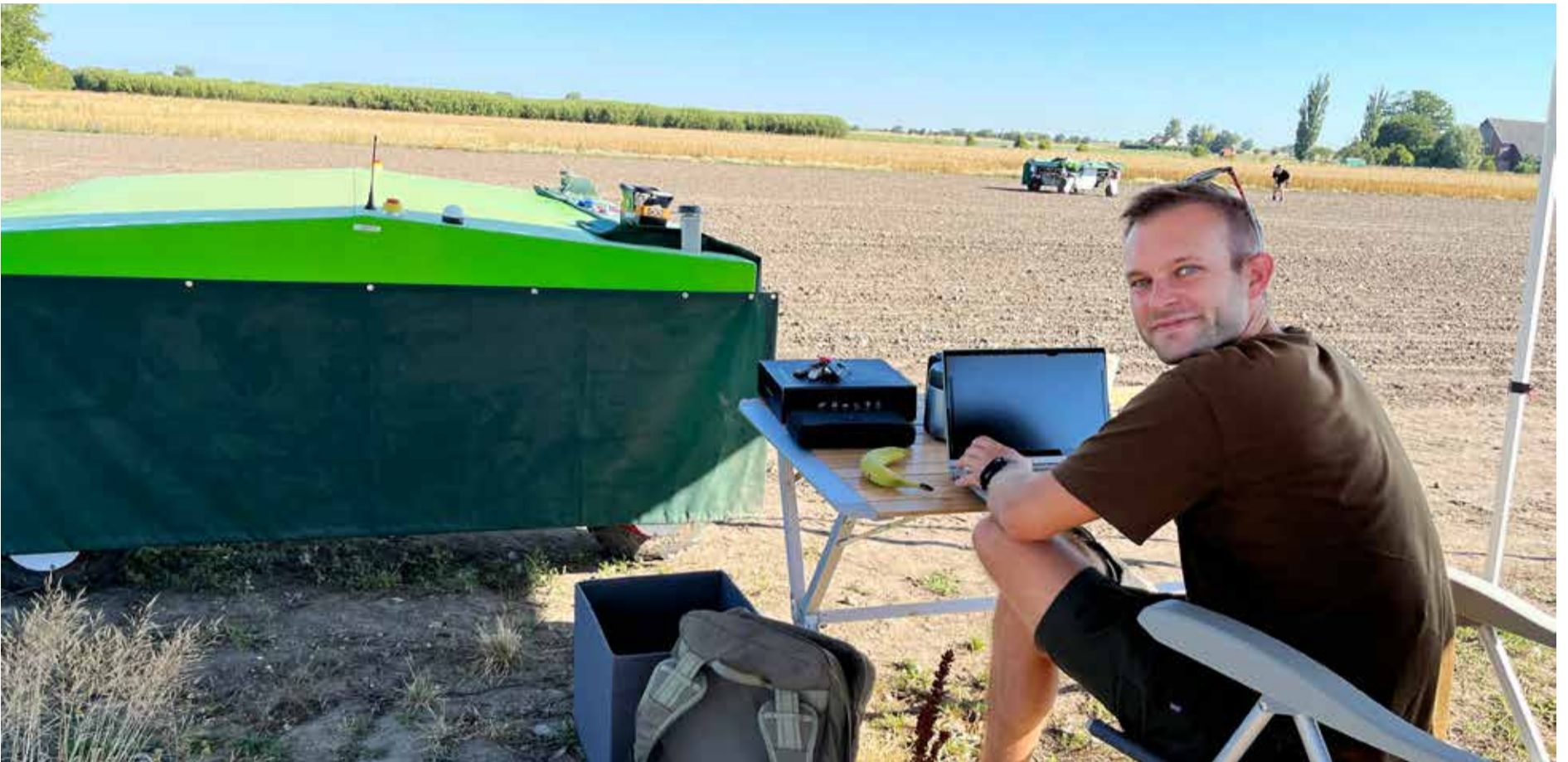
Robin sitter i fält och programmerar in hur roboten skall arbeta. Här reglerar och styr han hur snabbt och ofta den skall köra, vad som är ogräs, hur nära den skall rensa från lökraden, hur djupt den skall bearbeta, var den skall ladda och var den skall köra på fältet. Modernt lantbruk som kräver mycket kunskaper om både biologi, mekanik och IT.
