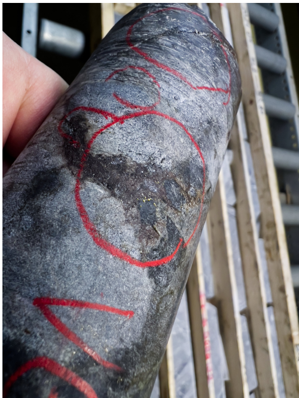
Figur 2: Borrkärna från Stortjärnhobben med synligt guld
