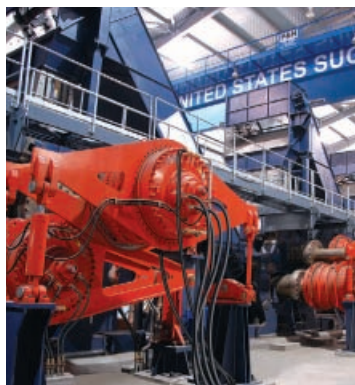
Krossningstandemet på US Sugars nya linje i Florida med världens högsta krossningskapacitet drivs av system från Hägglands Drives.
