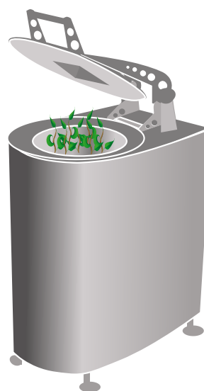
Sticklingar placeras i behandlingskammaren. Locket stängs och vakuumimpregneringen påbörjas.
