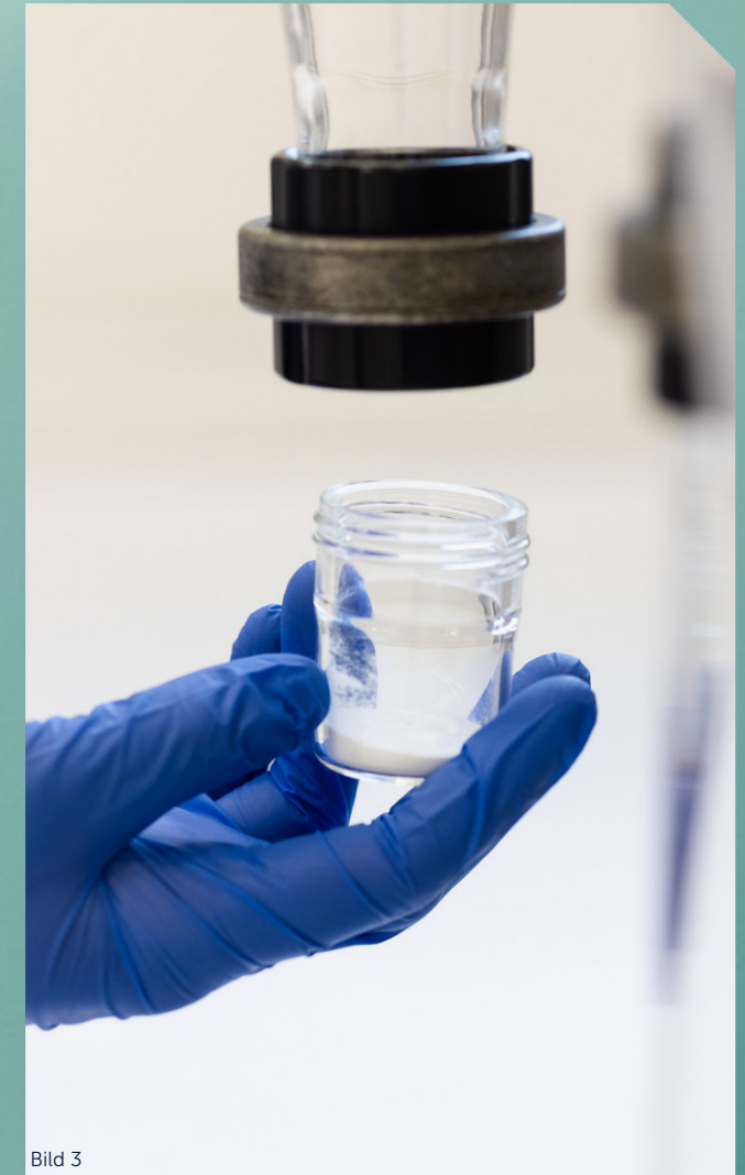
Bild 1: Substanslösning som i nästa steg spraytorkas till pulver. Bild 2: Kontrollsystem för spraytork. Bild 3: Spraytorkat AmorphOX-pulver.
