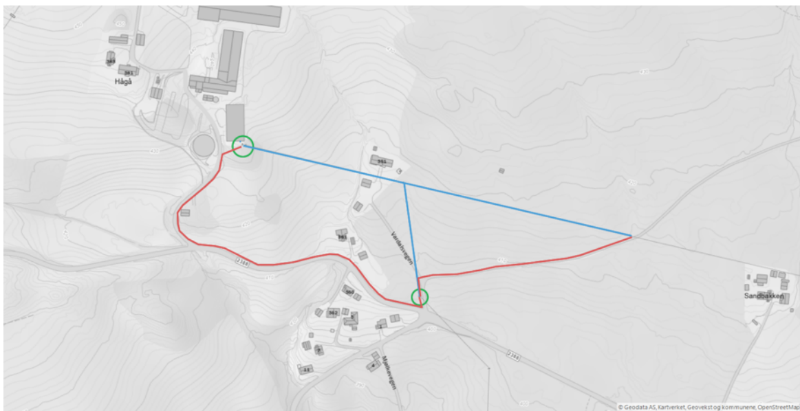
Figur 3-9 Eksisterende 11 kV som går gjennom planområdet og sannsynlig ny kabeltrase for dette nettet
