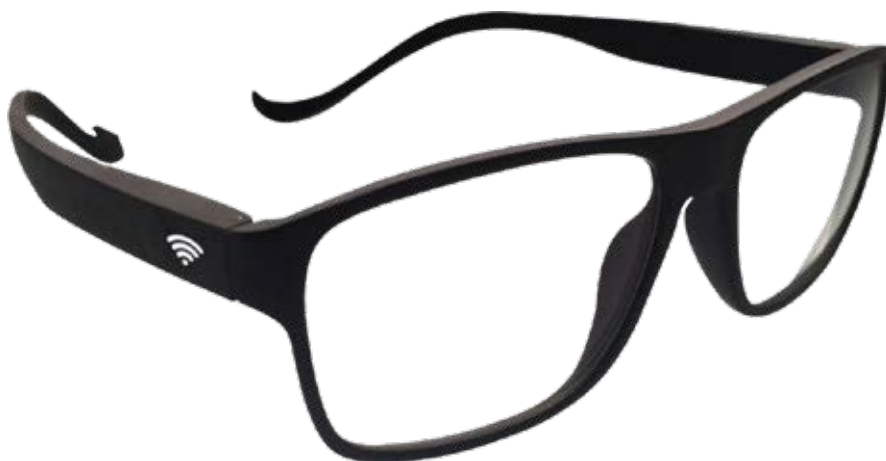
Glasögon med sensorer för medicinskt bruk. Om bäraren ramlar går en signal till en fjärrövervakningsplattform som larmar anhöriga eller sjukvård.
