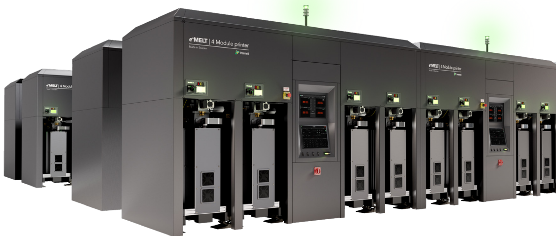
Freemelts 3D-printer, eMELT-iM® illustrerad på ett fabriksgolvet
