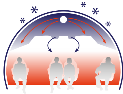
Princip: Fuktig luft blåses in i kabinen (blå pilar) vilket ger en behaglig luftfuktighet för passagerarna i kabinen. Torr luft (röda pilar) från avfuktare förhindrar kondensproblem.
