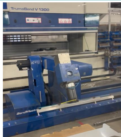
TRUMPF TrumaBend V1300 är en hydraulisk kantpress som används för bockning av plåtmaterial.
