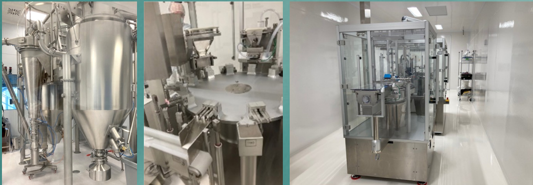
Bilder; Spraytork och fyllningsutrustning som används vid Orexos FDA-inspekterade produktionsanläggningar.
