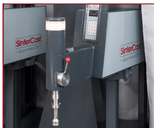
Ombyggd SAM med förbättrad termoelementhållare
