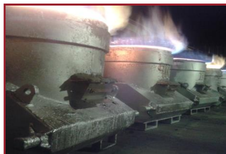
RFID-skänktaggarna fästa vid varje skänk
