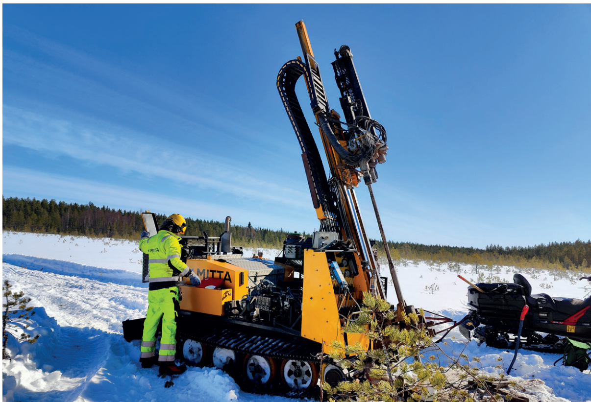
Jordmånsbas och berggrundsborrning och geokemisk provtagning under maj 2023 vid projektet Pääneva i Kiimala Trend.
