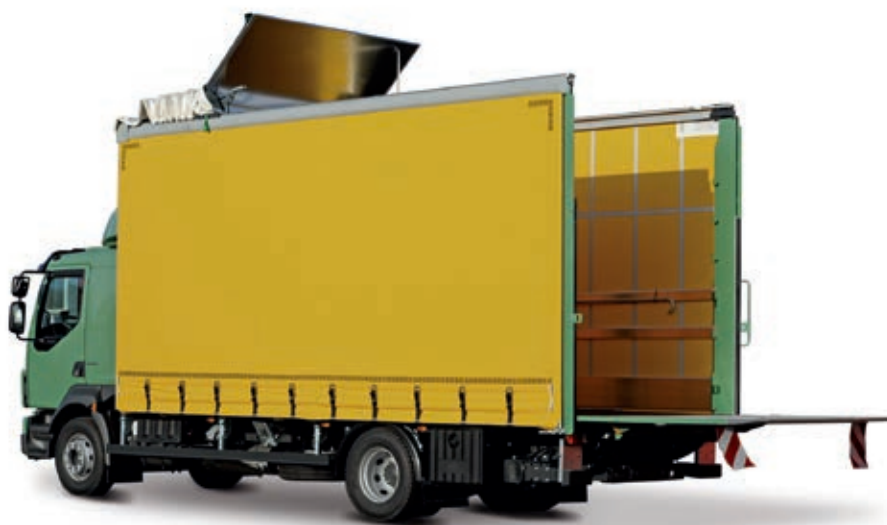
Den nya innovativa öppningskonstruktionen Edscha TailWing som nominerats till Trailer Innovation Prize 2013. Bilden visar när det skjutbara taket med Edscha TailWing helt har öppnats.
