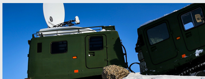
Kebni Satmission Drive-away antenn installerad på militär bandvagn
