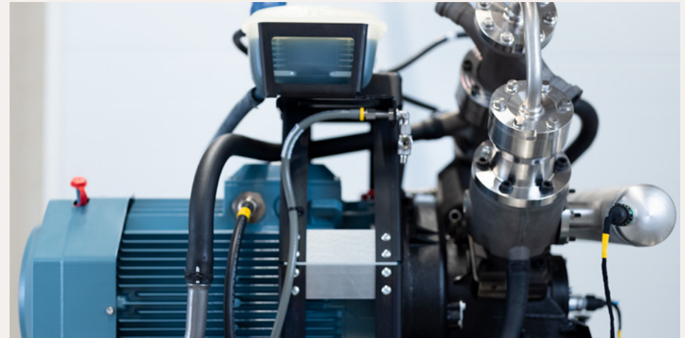
Stirlingmotorn drivs av värme som omvandlas till rörelseenergi som driver en generator och levererar elektricitet.
