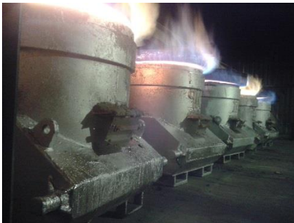
固定在浇包上的无线射频识别器（电子标签）
